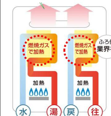
お湯をつくる時に発生する燃焼ガスを再利用して加熱することで、熱効率が上がりランニングコストを抑えられるしくみになりました。また、約200°Cもの排熱を捨てずに利用することで排熱温度が約50°Cまで下がりCO2排出量も削減できるようになりました。
